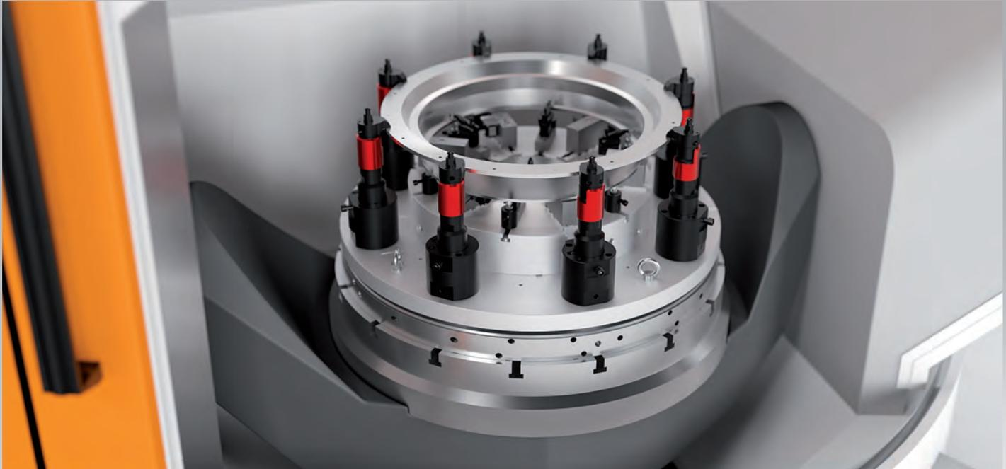
In der Fräs- und Drehbearbeitung sind Kabel durch die wechselnde Positionierung der Drehtische oft der Bearbeitung im Weg oder bieten nicht die notwendige Flexibilität, um den Bewegungen der Vorrichtung zu folgen. Durch den Einsatz der AMF-Funksensorik kann die Werkstückauflage einfach und prozessicher abgefragt werden und das ohne aufwendig Kabel zu verlegen.
